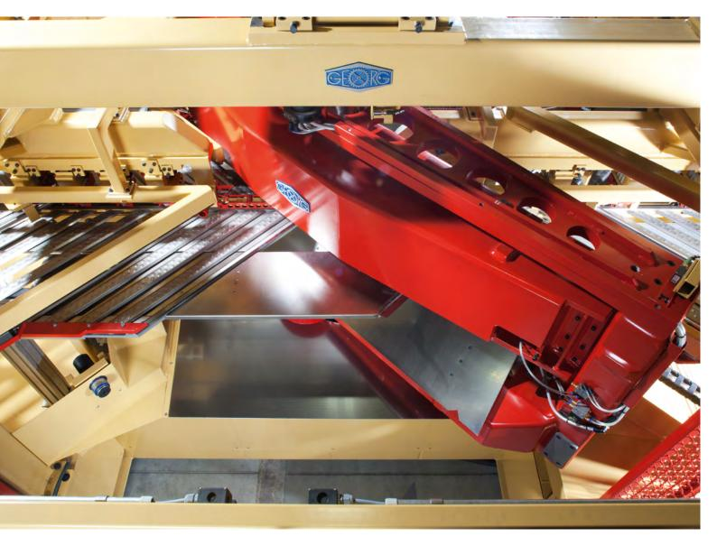
步进铁心片剪切线 **乔格高精确**剪切线 TBA 1200 S
